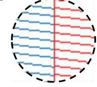
FIGURE 3-5 GOOD NOZZLE TEST PRINT
